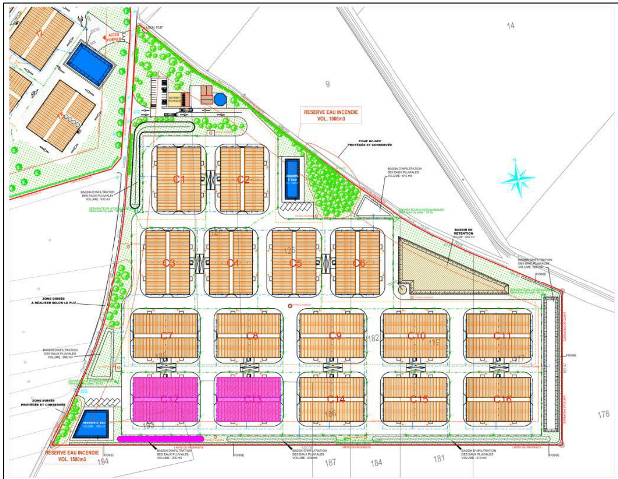
Figure 16 : Surfaces captées par le bassin n°3
