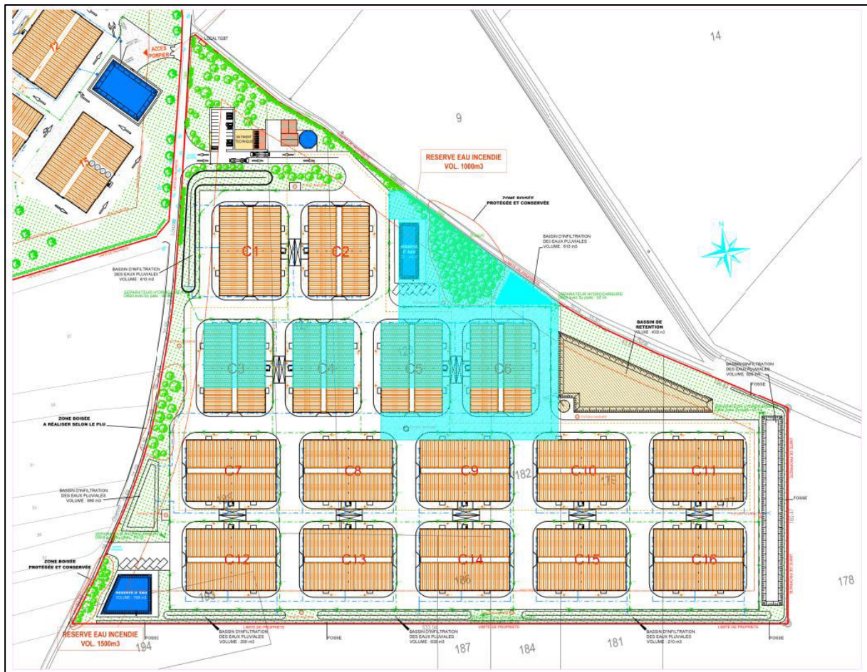
Figure 22 : Surfaces captées par le bassin n°6
