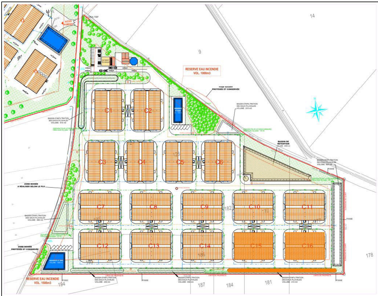
Figure 12 : Surfaces captées par le bassin n°1
