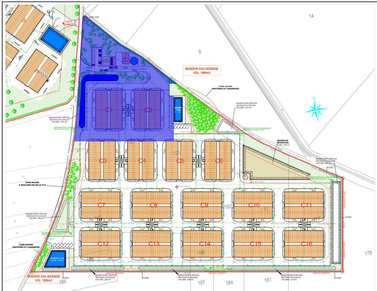
Figure 20 : Surfaces captées par le bassin n°5
