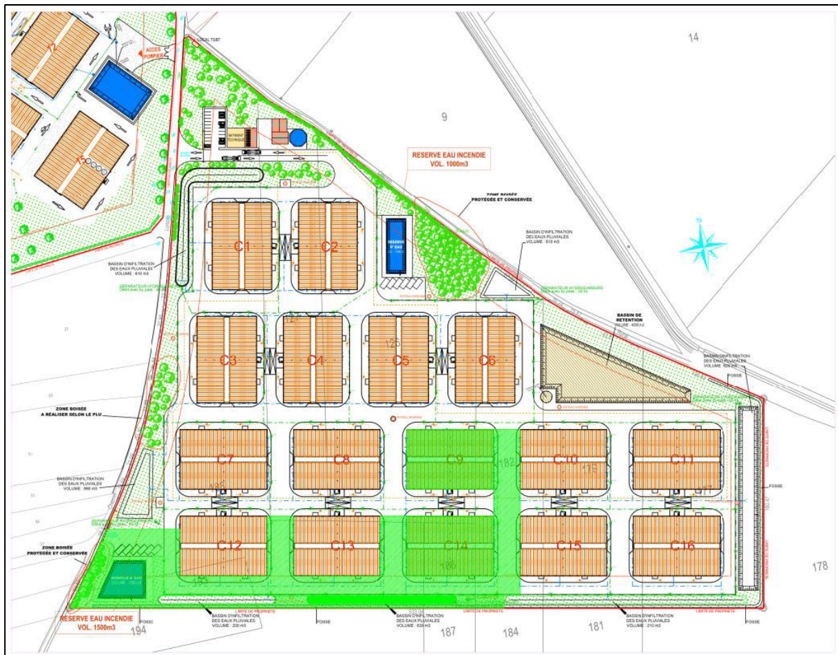
Figure 14 : Surfaces captées par le bassin n°2
