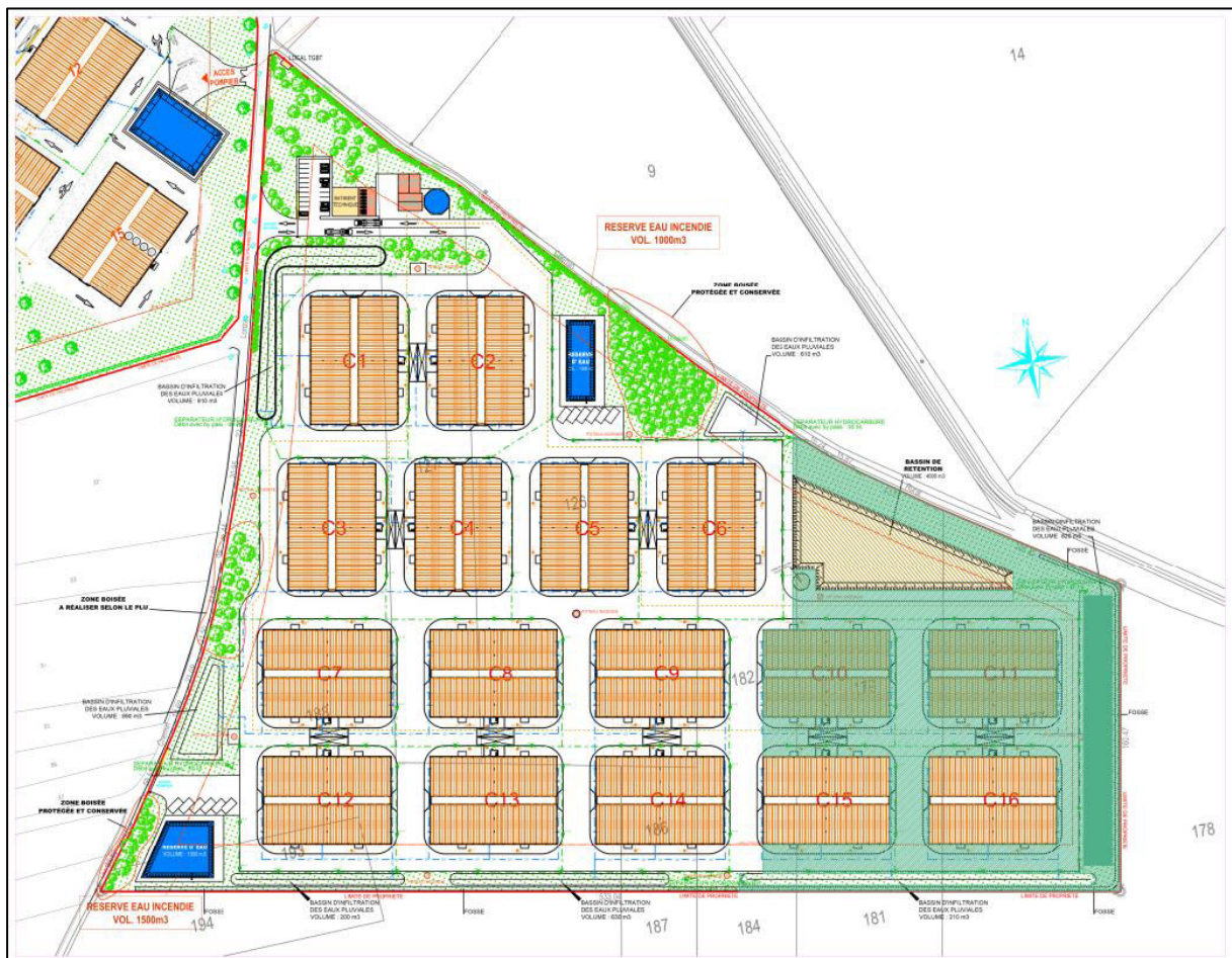
Figure 24 : Surfaces captées par le bassin n°7
